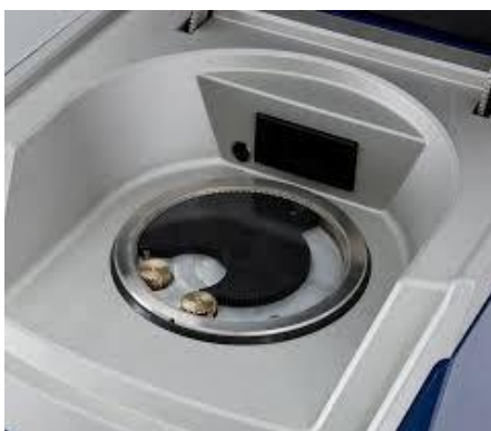
Foto n° 02 – Vista do NIRS™ DS 2500 posicionado para análise (foto A) e bandeja rotativa ou acessório de cuvetas para sólidos e líquidos (foto B) do analisador de espectroscopia, modelo DS 2500, do fabricante Foss.
